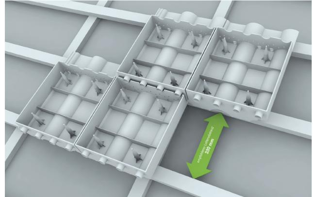
Lattenabstände: min 325 mm / max. 345 mm
